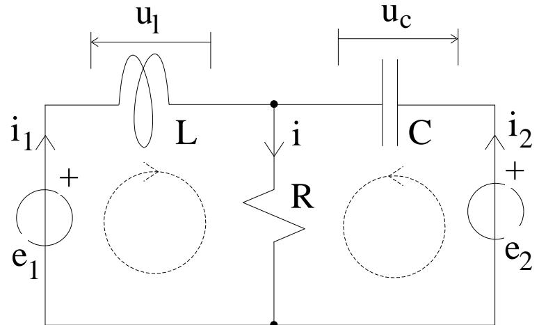
$$\begin{bmatrix} \frac{di_1}{dt} \\ \frac{du_C}{dt} \end{bmatrix} = \begin{bmatrix} 0 & \frac{1}{L} \\ -\frac{1}{C} & -\frac{1}{RC} \end{bmatrix} \begin{bmatrix} i_1 \\ u_C \end{bmatrix} + \begin{bmatrix} \frac{1}{L} & -\frac{1}{L} \\ 0 & \frac{1}{RC} \end{bmatrix} \begin{bmatrix} e_1 \\ e_2 \end{bmatrix}$$
